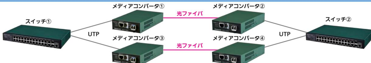
メディアコンバータ①～④のモード切替スイッチは「**AUTO+RELAY モード**」に設定してご使用ください。リンクアグリゲーションの設定は、LACP でなく、マニュアル設定をご利用ください
