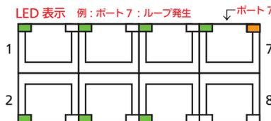
ループを検知した場合、60秒間（60秒～86,400秒の設定変更可能（iGシリーズは設定変更不可））ポートが遮断され、同時にループ発生ポートのLEDが橙色点灯することでループが発生したことを表示します。60秒後にループが解消されていない場合には、再度60秒間ポートが遮断されます。LED表示切替ボタンを10秒長押しするか、設定画面上で設定変更することでループ検知・遮断機能のOFF/ONが可能です。（特許第5647417号）
