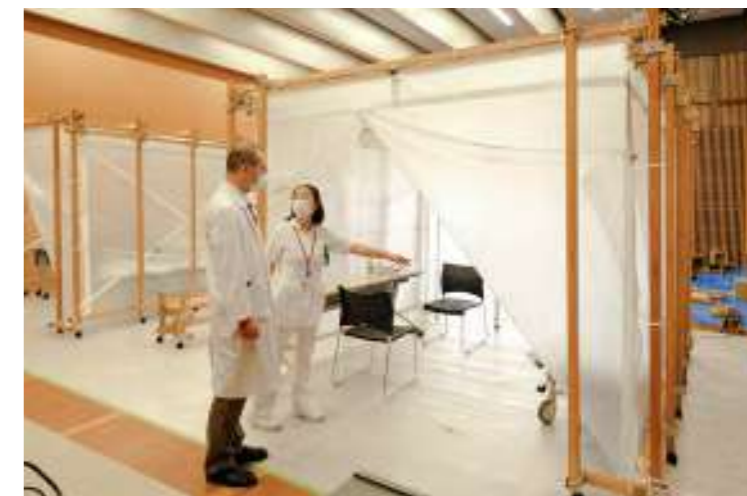
医療の現場をつなぐ 足利赤十字病院での「もしもつな木」 普段はベンチやカフェブースとして使用しているもしもつな木を、緊急時には仮設医療ブースに組み換えることができます。 コロナ感染者用の病床確保対策として利用できます。
