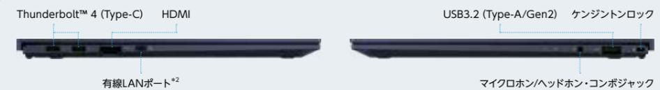
※2 有線LANでの接続の場合は、付属のmicroHDMIイーサネットアダプター (LANアダプター) を接続してください。
