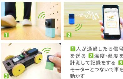
1人が通過したら信号を送る 2温度・湿度を計測して記録をする 3モーターとつないで車を動かす
