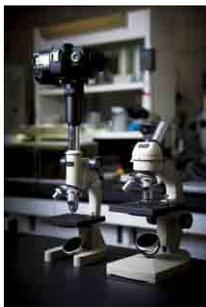
一眼レフカメラを載せても、鏡筒が落下せずしっかりと安定するラックピニオン。
